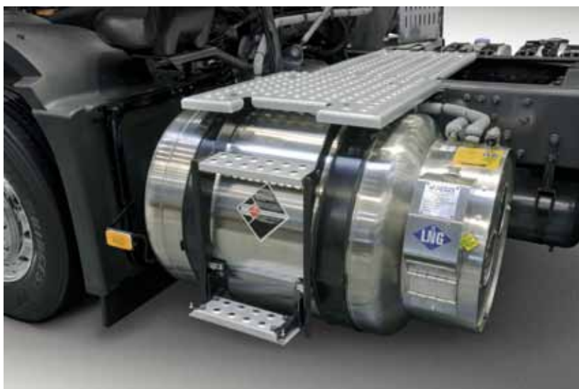
De brandstoftanks zijn goed geïsoleerd Bron: Jan van den Berg
